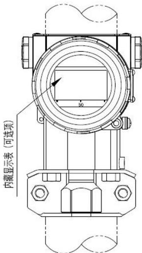
图 3 水平配管连接方式（正面）
