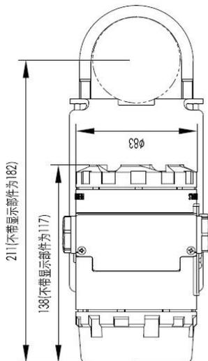
图 4 水平配管连接方式（侧面）
