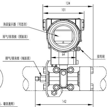
图 8 水平配管连接方式 (正面)
