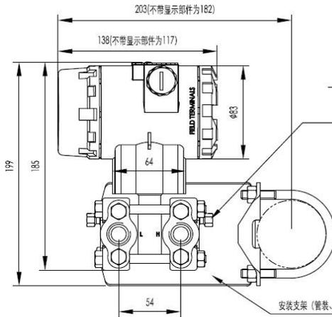
图 7 水平配管连接方式 (侧面)
