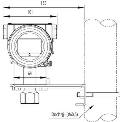
图 6 垂直配管连接方式
