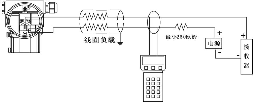
图 11 HART 通讯连接图
