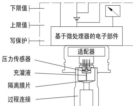
图 1 压力(绝压)变送器
