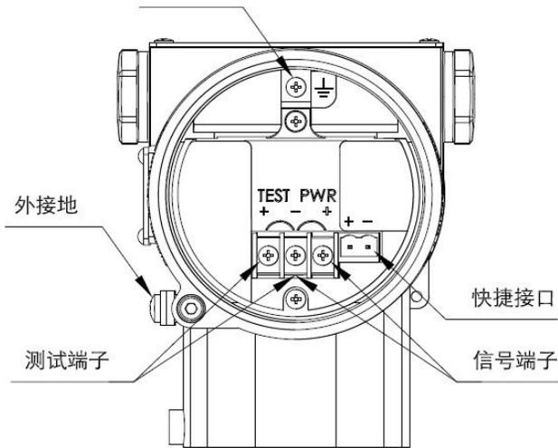
图 12 电气连接图
